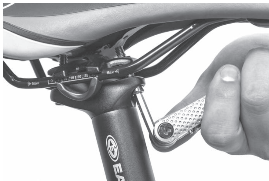
Рисунок 17. На верхнем фото показана конструкция двухболтового штыря. Для изменения наклона седла используйте шестигранник (на нижнем фото), которым попеременно ослабляйте один болт и затягивайте другой
