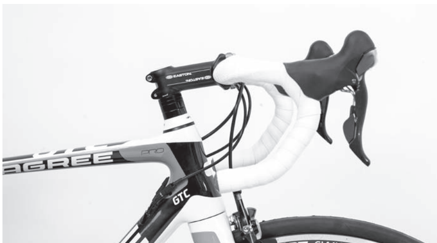
Рисунок 12. На фото показана базовая позиция руля относительно выноса. В большинстве случаев она наилучшим образом подходит для комфортного катания. Если настройкой углового положения руля Вы не можете добиться удобного для себя положения, возможно, необходимо отрегулировать положение комбинированных ручек — это сложная и требующая аккуратности операция, которую лучше поручить профессиональному веломеханику.
