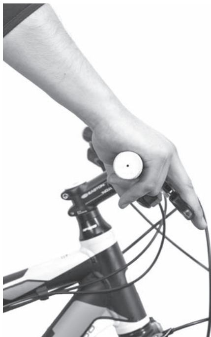
Рисунок 5. Установите руль и тормозные ручки на нем так, чтобы при езде кисти и пальцы рук находились на одной прямой и не заламывались ни в какую сторону
