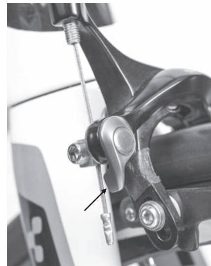
Рисунок 20. Для облегчения снятия и установки колеса ободные тормоза шоссейных велосипедов имеют специальный рычаг (показан стрелкой). Его положение рычажком вверх означает «расстегнутый тормоз». Положение рычажком вниз означает «зафиксированный тормоз»
