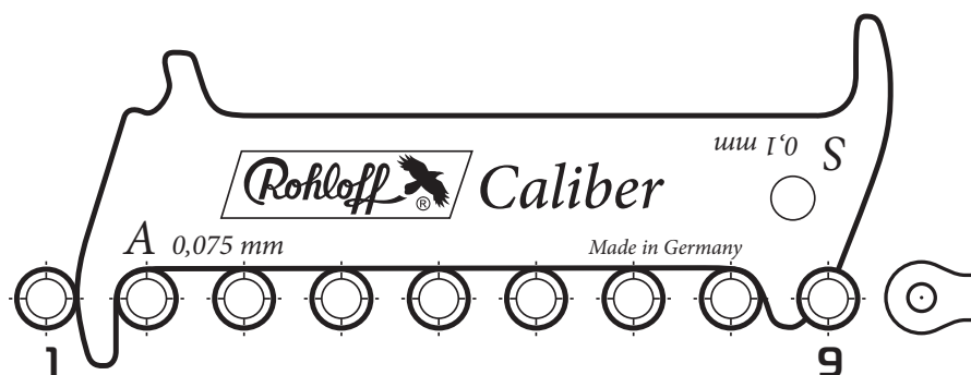
Рисунок 7. Цепной калибр позволяет предупредить начало износа зубьев звёздочек из-за слишком сильно изношенной и растянутой цепи
