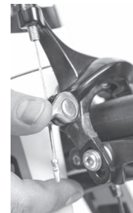
Рисунок 20. Для облегчения снятия и установки колеса ободные тормоза шоссейных велосипедов имеют специальный рычаг (показан стрелкой). Его положение рычажком вверх означает «расстегнутый тормоз». Положение рычажком вниз означает «зафиксированный тормоз»
