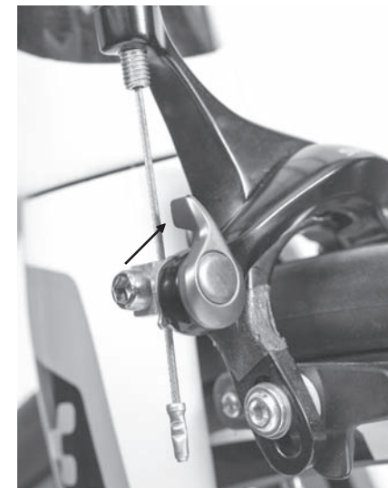
Рисунок 20. Для облегчения снятия и установки колеса ободные тормоза шоссейных велосипедов имеют специальный рычаг (показан стрелкой). Его положение рычажком вверх означает «расстегнутый тормоз». Положение рычажком вниз означает «зафиксированный тормоз»
