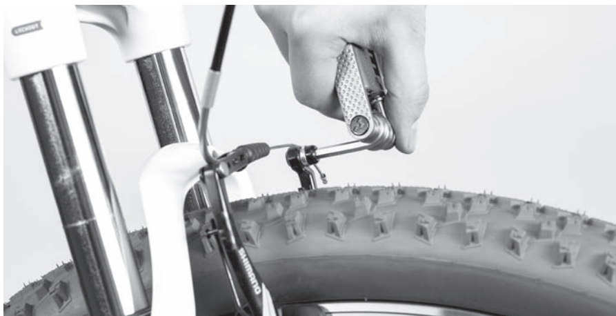
Рисунок 18. Затяжка тормозного тросика на тормозах типа V-brake
