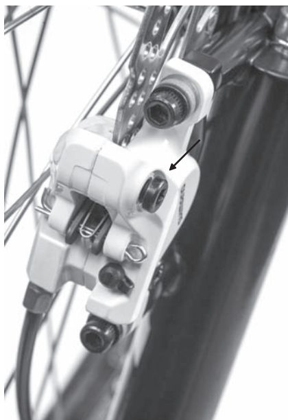
Рисунок 6. Недостаточно затянутый винт крепления — повод к поломке узла велосипеда, возможной травме велосипедиста и причинению материального ущерба!
