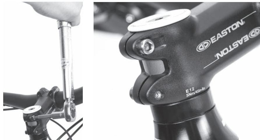
Рисунок 13. Для затяжки винтов крепления выноса также настоятельно рекомендуется использовать динамометрический ключ. Требуемый момент затяжки винтов обычно указан на выносе (см. фото справа)
