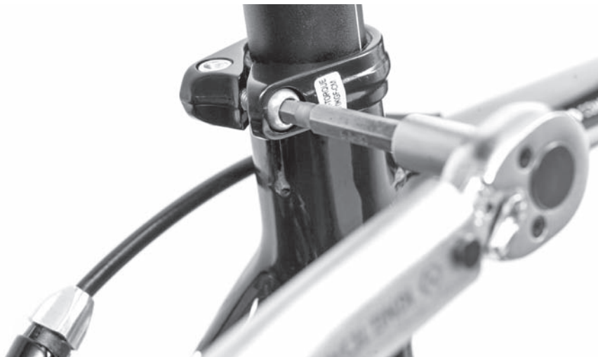
Рисунок 16. Для фиксации подседельного штыря в раме с помощью винтового зажима обязательно использовать динамометрический ключ. Требуемый момент затяжки винта указан на винтовом зажиме
